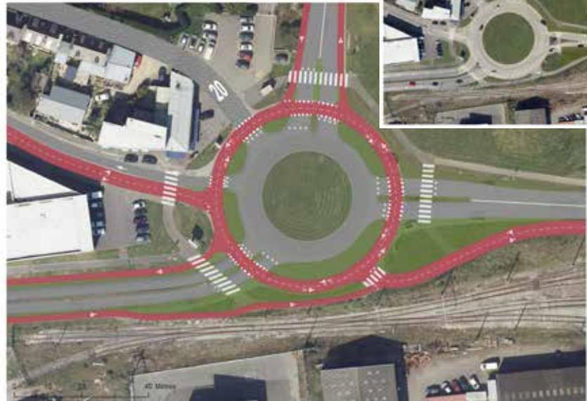
Rond-point Herman Melville, Brest. Exemple de reconfiguration d'un rond-point pour le rendre compatible avec la circulation de vélos. Une piste cyclable bidirectionnelle, colorée, séparée et protégée par des îlots remplace une bande cyclable implantée en périphérie du rond-point.
